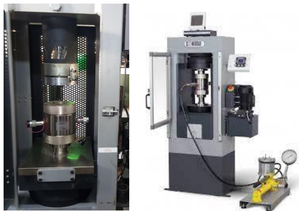
Зураг 5. Чулуулгийн суналт, нэг болон гурван тэнхлэгийн шалгалтын бат бэх тодорхойлох багаж
