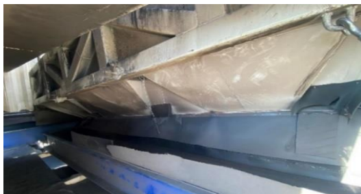
2-р зураг. XDF-10 төхөөрөмжийн хаягдал гарах хэсэг. (Ширээний уртын дагуу хаягдал нь ширхэглэлээр ангилагдан гурван хэсэг хаягдал гарна.)
