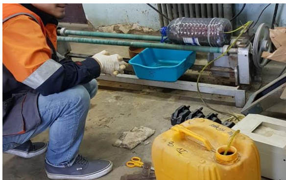
5-р зураг. Цементацийн тасралтгүй процессын туршилтын явц
