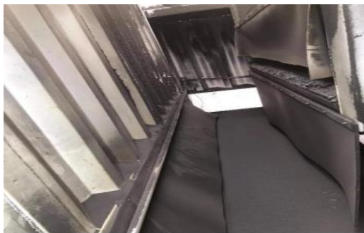
3-р зураг. XDF-10 төхөөрөмжийн баяжмал гарах хэсэг. (Ширээний төгсгөлд баяжмал гарна.)
