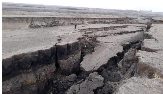
Зураг-3. Хатаах үйлдвэрийн баруун хойд хэсэгт үүссэн хагарлын шугам 2018 оны 5-р сарын 30-ны байдлаар
