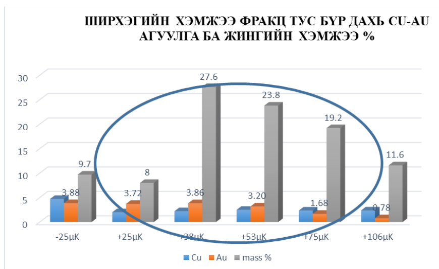
Зураг 9. Дахин нунтаглалтын гидроциклоны доод бүтээгдэхүүн дахь Cu-Au хэмжээ ба агуулга
