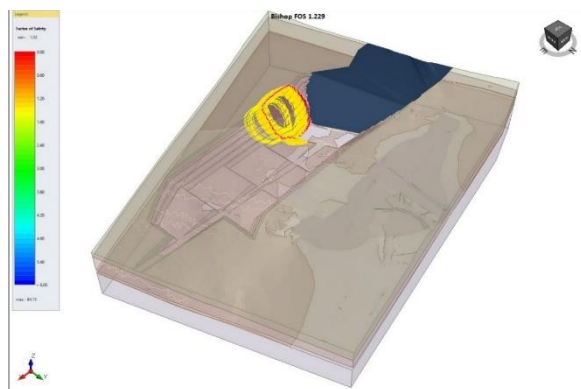
Зураг 25. Ил уурхайн ашиглалтын 2-р жилийн төлөвлөлтийн дизайнд дээрх LEM анализийн дугуй цилиндр гулсалт (нуралт)-ын FOS < 1.5 үеийн бүх гадаргуу, нийт 243 ширхэг (NE - SW)
