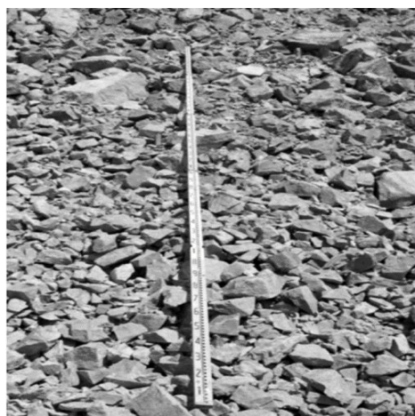
12-р зураг. 6. Бутлагдсан хүдрийн мөхлөгийн бүтцийг планометрийн аргаар хэмжиж буй байдал
