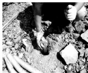
1-р зураг. Тэсэлгээний цооногийн дагууд агаарын хоолойг байрлуулах байдал.
