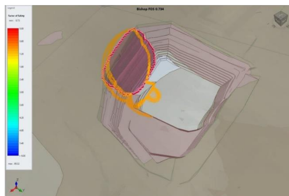
Зураг 15. Судалгааны модел дээрх LEM анализийн дугуй цилиндр гулсалт (нуралт)-ын FOS < 1.0 үеийн бүх гадаргуу, нийт 52 ширхэг (NE - SW)
