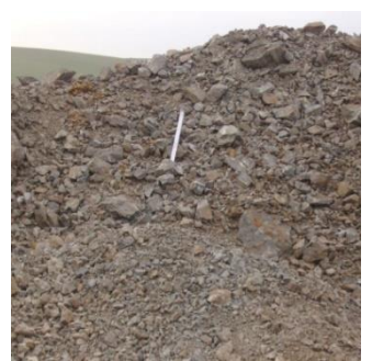
6-р зураг. Ширхэглэлийн хэмжээг хэмжилтийн аргаар тодорхойлсон хэсэг /дундаж бутлагдлын хэмжээ 0-0.2 м/
