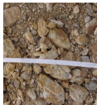
3-р зураг. Ширхэглэлийн хэмжээг хэмжилтийн аргаар тодорхойлсон хэсэг /дундаж бутлагдлын хэмжээ 0.6-0.9 м/
