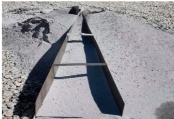
в). Цооногийг өрөмдсөний дараах "гадна дэлбээ" дэх дээж
