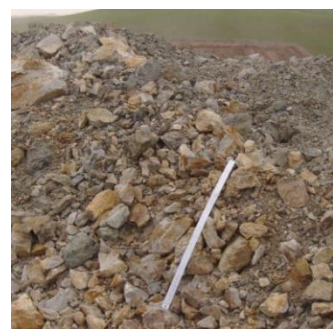
5-р зураг. Ширхэглэлийн хэмжээг хэмжилтийн аргаар тодорхойлсон хэсэг /дундаж бутлагдлын хэмжээ 0.2-0.4 м/
