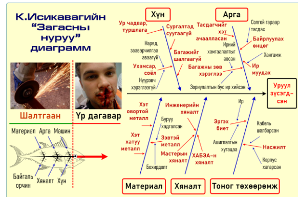
5–р зураг. Металл тасдагчаар уруулаа зүссэн шалтгааныг “Загасны нурууны ясан диаграмм” аргачлалаар тогтоосон байдал
