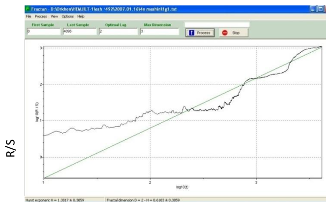
Рис.2. Нормированный размах виброускорений подшипника подъёмного редуктора экскаватора ЭШ-20.90
