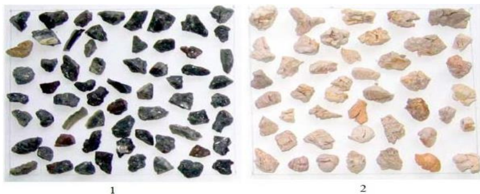
1.5. Жижиг перлитийн гадаад төрх (5-10мм хэмжээтэй) /1 –түүхий, 2 –Хөөлгөсөн/
