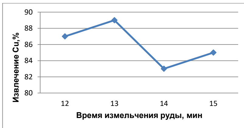
Рис. Влияние времени измельчения руды на извлечение Cu при флотации
