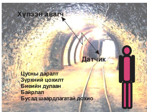
1-р зураг. Zigbee системийн далд уурхайн ашиглалт
