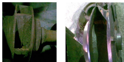
а б Рисунок 2. Рабочие колеса насосов: а – закрытого типа; б – полужакрытого типа
