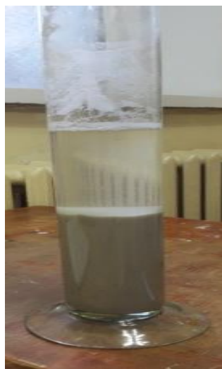
12-р зураг. Эргэлтийн усыг ашиглан тунаасан байдал
