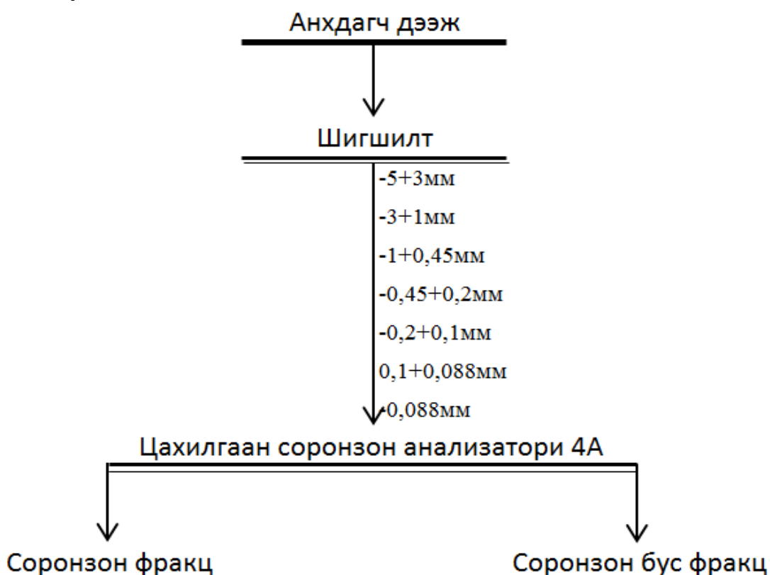
6-р зураг. Цахилгаан соронзон анализатораар (Davis Tube) баяжуулсан туршилтын технологийн схем
