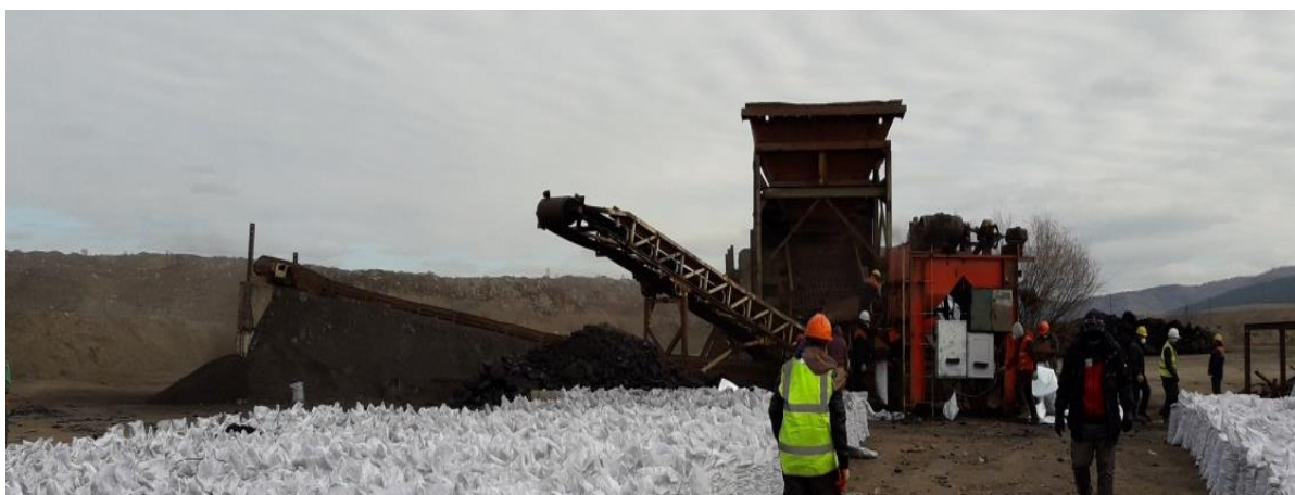
2-р зураг. Нүүрс шигшин, ялгаж шуудайлах механизмын туршилтын үе
