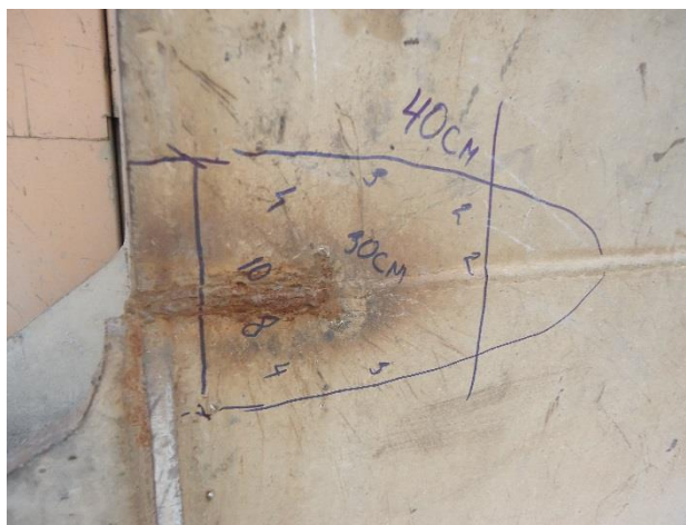
2-р зураг. Драглайн босоо баганад үүссэн цууралт эргэн тойронд үүссэн эгэл ан цавшилтын бүс, 2-оос 10 хүртлэх тоон тэмдэглэгээнүүд нь ан цавшилтын хэмжээг илэрхийлнэ. 7
