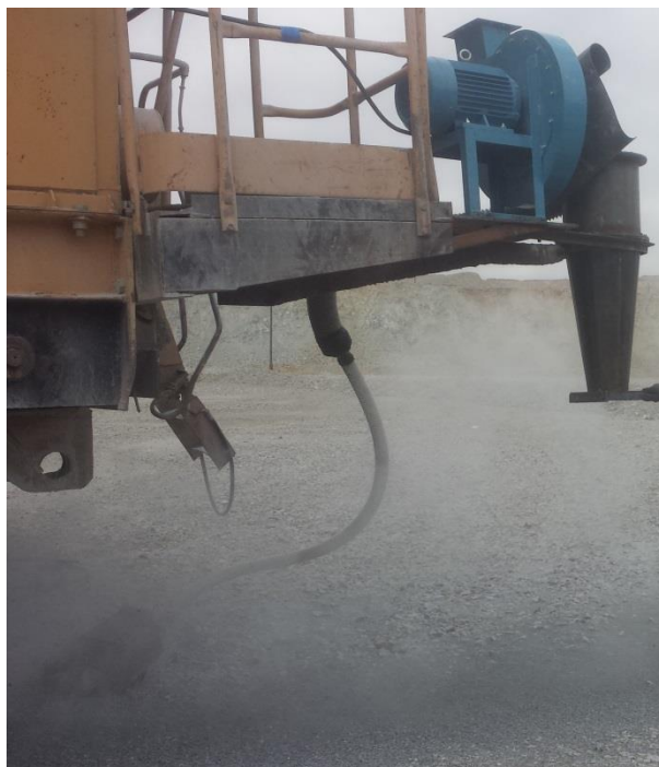
7-р зураг. Дээж авах төхөөрөмжийг өрмийн машинд суурилуулсан байдал
