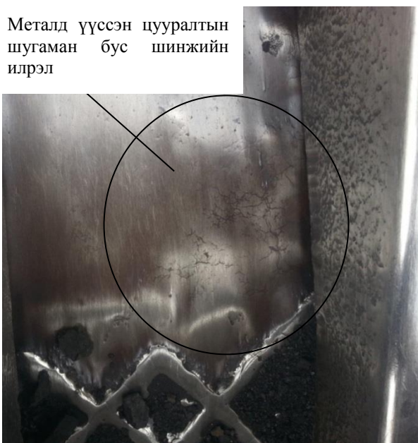
1-р зураг. Шууд утгуурт экскаваторын шанаганы хажуу хананд үүссэн ан цавшилт, цууралтын бүс
