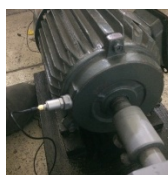
1-р зураг. Акселерометрийн байрлал, а) босоо тэнхлэгийн дагуу б) хэвтээ тэнхлэгийн дагуу в) хөдөлгүүрийн голын дагуу
