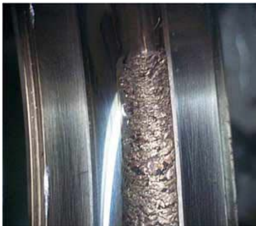
Холхивчны дотор объем элэгдсэн байдал
