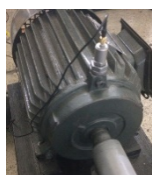
1-р зураг. Акселерометрийн байрлал, а) босоо тэнхлэгийн дагуу б) хэвтээ тэнхлэгийн дагуу в) хөдөлгүүрийн голын дагуу
