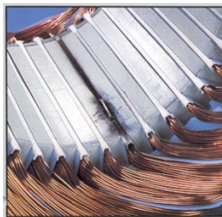
Ороомог хоорондын тусгаарлал муудаж буудаж тасарсан байдал
