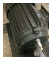
1-р зураг. Акселерометрийн байрлал, а) босоо тэнхлэгийн дагуу б) хэвтээ тэнхлэгийн дагуу в) хөдөлгүүрийн голын дагуу
