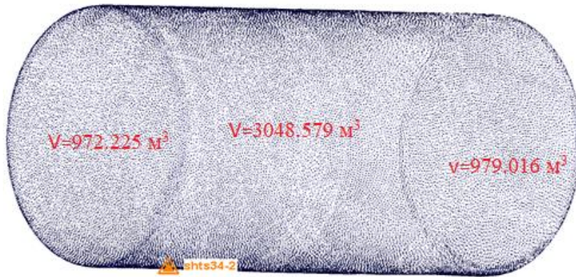
Зураг 2.2 Нөөцлөх савыг лазер сканнераар хэмжин эзэлхүүнийг харуулав.
