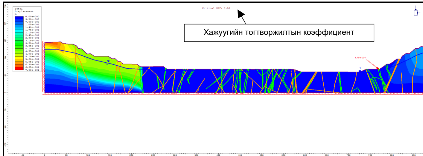
Зураг 29. VI-VI хөндлөн зүсэлт, 2016.11.25-нд тэслэгдсэн Блок 1-ийн цохилтын хэмжилтээр тодорхойлсон уурхайн хажуугийн тогтворжилтын шинжилгээний үр дүн
