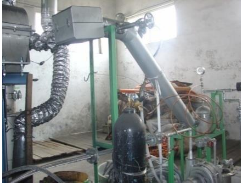
Зураг 2. Хүрэн нүүрсийг хагас коксжуулах хагас үйлдвэрлэлийн туршилтын лаборатори.
