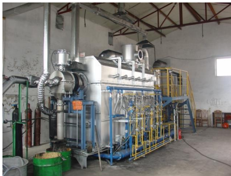
3-р зураг Лабораторийн хагас кокс үйлдвэрлэх үндсэн тоног төхөөрөмж
