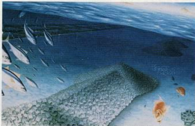
図-1 リサイクルブロックを積み上げた人工海底山脈の完成予想図
