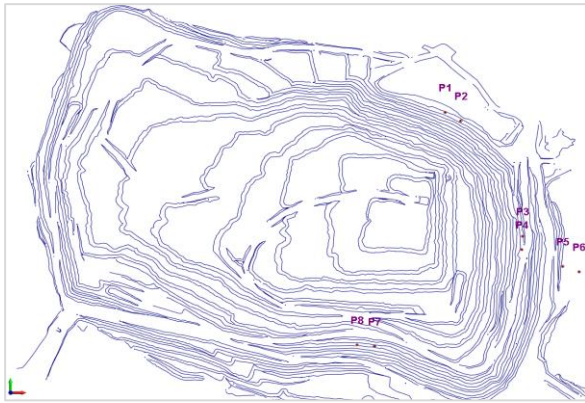
10-р зураг. Ил уурхайн зүүн хойд, зүүн болон урд хажуугийн ханануудад байгуулсан хяналтын цэгүүдийн(репер) байршил
