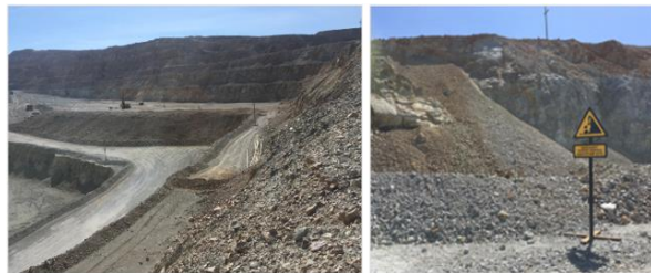
9-р зураг. Суулттай бүсийг тусгаарлаж хамгаалалтын далан хийсэн, анхааруулах тэмдэг байршуулсан байдал
