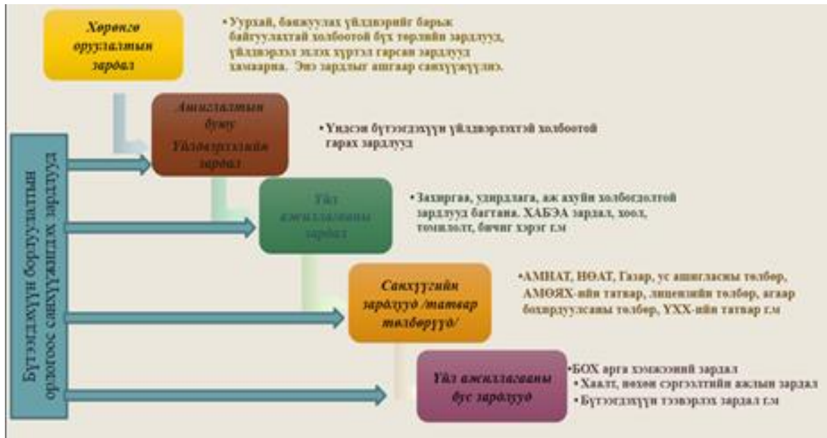
1-р зураг. Ашигт малтмалын орд ашиглах ТЭЗҮ, уурхайн төслийн эдийн засгийн бүлэгт тооцох зардлууд
