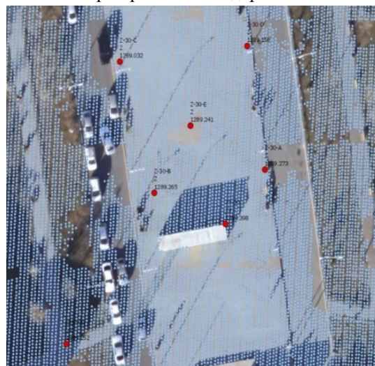
14-р зураг. LiDAR-ийн хэмжилтийн өндрийг шалгах зорилгоор бетон талбай дээр хийсэн холболтын цэгүүдийн хэмжилт
