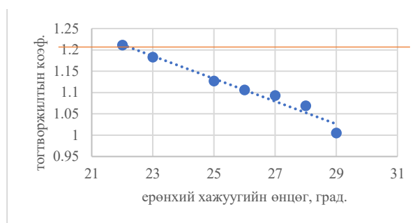
16-р зураг. А-А хөндлөн зүсэлтэд хамаарах ажлын талын ерөнхий хажуугийн өнцөг болон тогтворжилтын хамаарал
