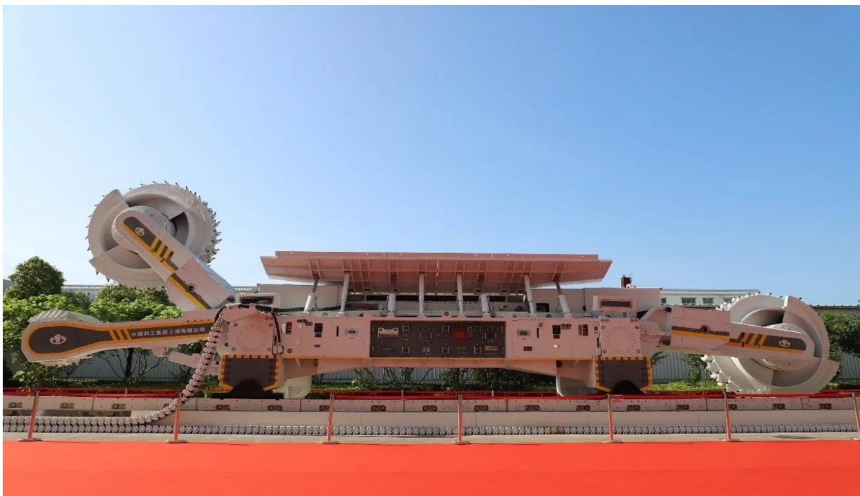
Зураг 1. Нүүрсний зузаан давхаргыг олборлох MG2×250/1200-WD1маркийн комбайн бүхий иж бүрэн механиксан тоног төхөөрөмж.
