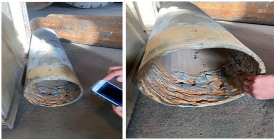
11-р зураг. Шавсан халианы хоолойг дахин ашиглаад 600 цаг яваад элэгдсэн байдал
