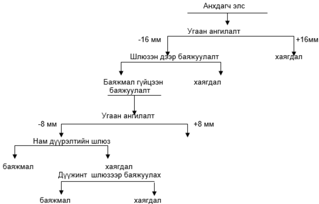
6-р зураг. Дүүжин шлюз дээр алтыг ялгах технологийн схем
