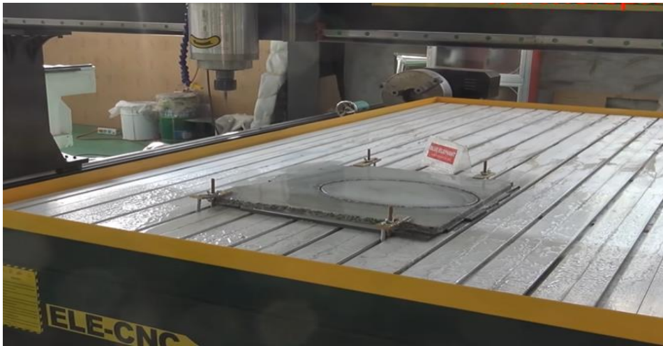
1-2р зураг: Чулуун материал дээр сийлбэр хийх CNC машин.
