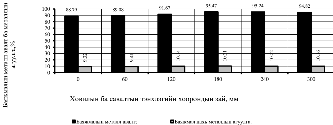
3-р зураг. Баяжмалын агуулга ба металл авалтын ховилын ба савалтын тэнхлэгийн хоорондын зайнаас хамаарсан хамаарал
