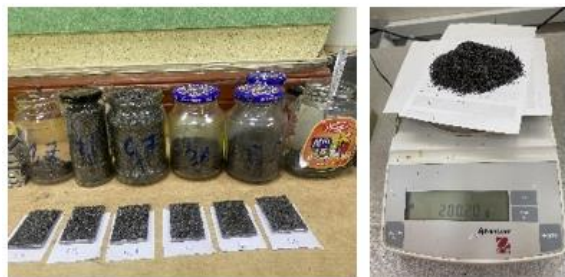
7-р зураг. Fe-Cr-C чанаржуулах материалаар бэлдэц тус бүр дээр бүрсэн байдал
