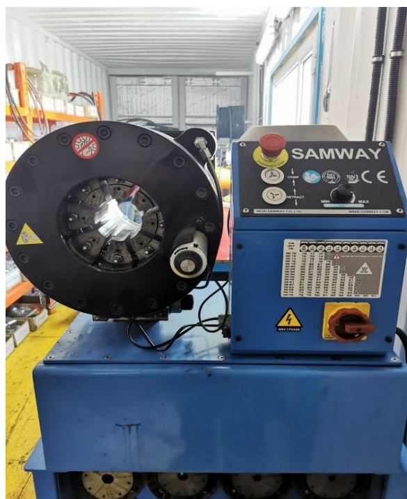
4-р зураг. Уурхайд ашиглаж байгаа Samway P32 маркийн хоолой базах төхөөрөмж
