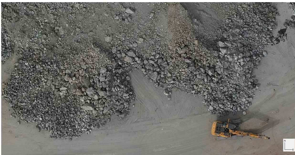
8-р зураг. Баргилтын ил уурхайн төмрийн хүдрийн овоолгын дээрх овор хэтэрсэн хүдрүүдийг дахин буталж жижиглэсэн байдал
