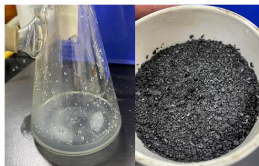
10-р зураг. Дээжийг идэвхжүүлсэн нүүрсээр шүүж буй байдал
