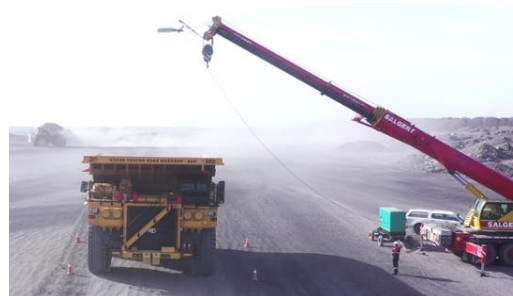
3-р зураг. Load Scan MPS-3X сканерыг суурилуулсан байдал
