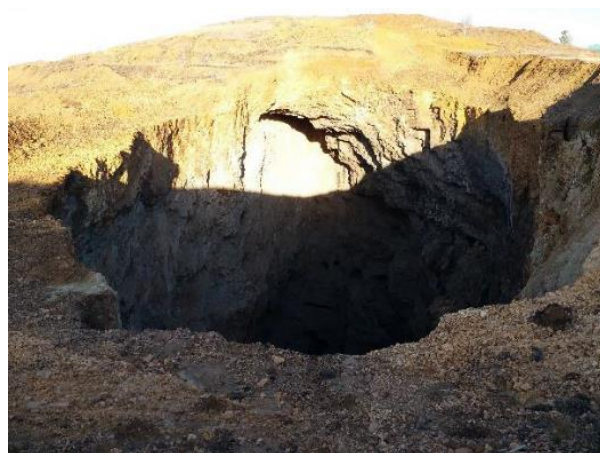
6-р зураг. Улааны далд уурхайн 1-р хүдрийн биетийн гадаргууд суулт үүссэн байдал [4]
