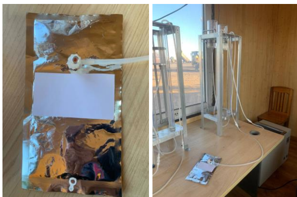
6-р зураг. Хийн дээжний уутанд хийг хуримтлуулж буй байдал
