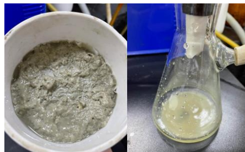
9-р зураг. Дээжийг бентонитоор шүүж буй байдал
