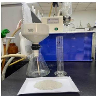
8-р зураг. Дээжийг цеолитоор шүүх гэж буй байдал
