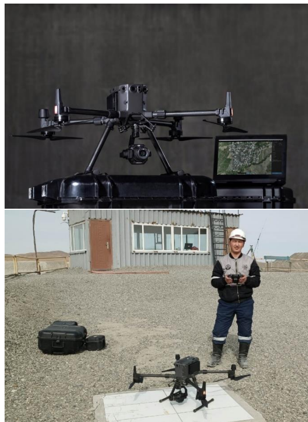
3-р зураг. Маркшейдерийн хэмжилт зураглалын өндөр нарийвчлал бүхий дрон /DJI M300 RTK/
