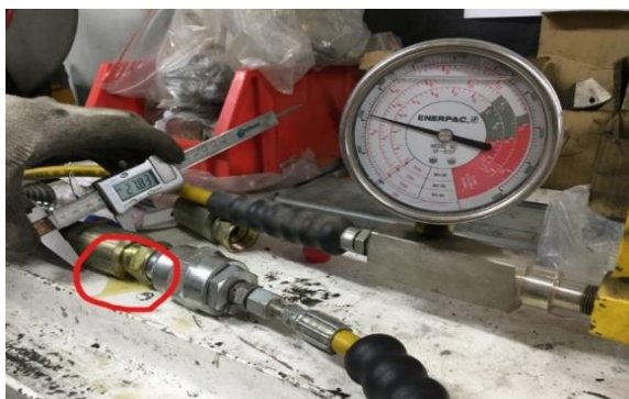
5-р зураг. Енергас Р-2282 өндөр даралтын гидравлик гар насос ашиглан фитинг суулгалтын битүүмжлэлийг туршилтаар шалгах нь
