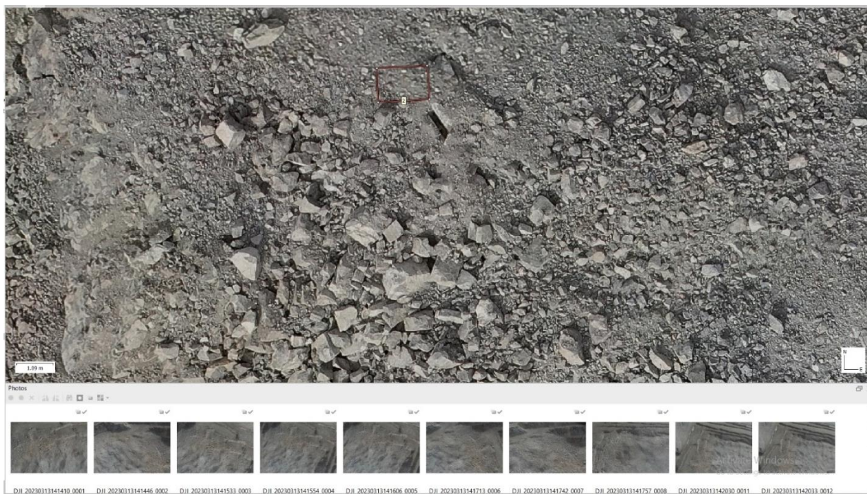
5-р зураг. Дроны өндрөөс авсан зургийг metashape программ дээр оруулсан байдал
