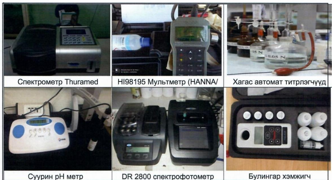
Зураг 2. Шинжилгээнд ашиглагдсан зарим багаж, хэрэглэгдэхүүн
