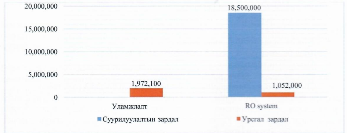
Ундны ус цэвэрлэгээний тоног төхөөрөмж, эдийн засгийн тооцоо, харьцуулсан дүн.
