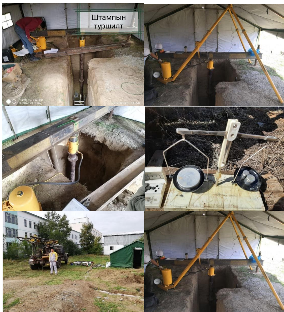
Зураг 3. Штампын туршилт болон хээрийн нөхцөлд эзлэхүүн жин тодорхойлох явц
