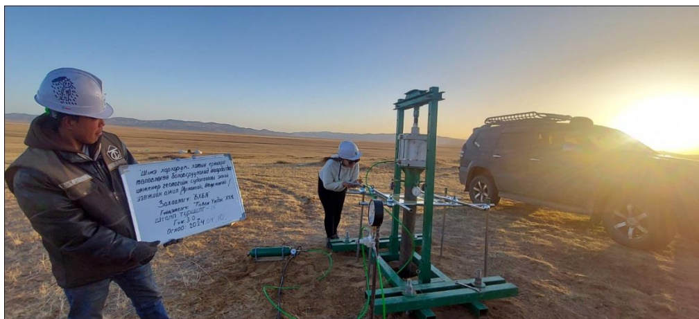
Зураг 2. “Изыскатель-600” маркийн штампын багажаар туршилт явуулж байгаа нь
