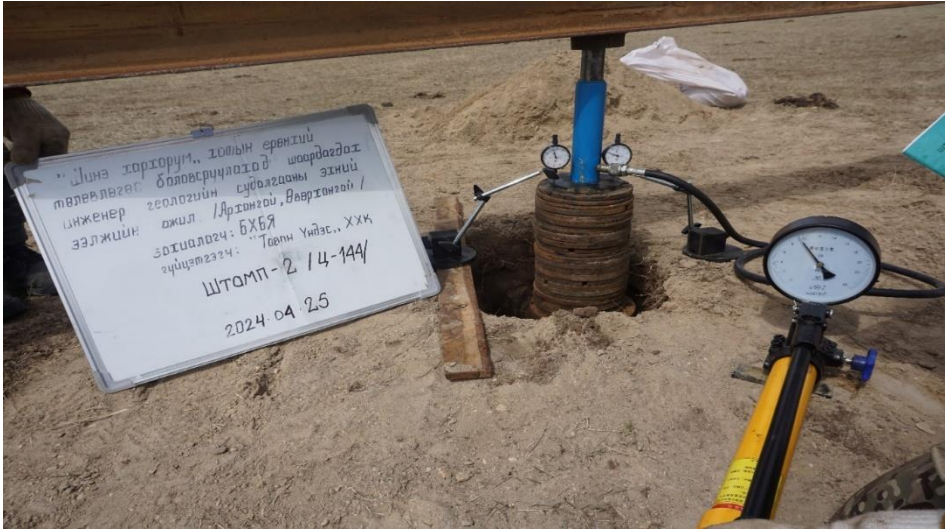
Зураг 3. Штампын туршилт явуулж буй үйл явцын харагдах байдал
