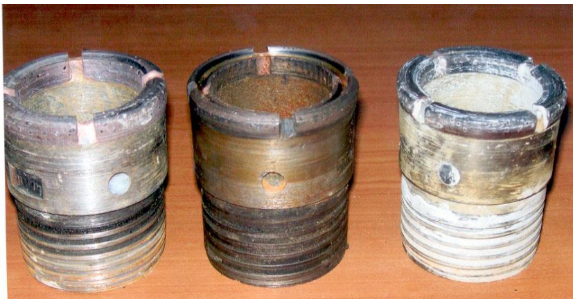
2 дугаар зураг. Ашиглалтын хайгуулын өрөмдлөгийн үед өргөн тохиолддог алмазан хушууны элэгдлийн хэлбэрүүд
