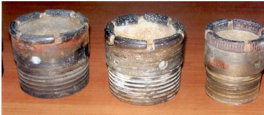
1 дугаар зураг. Ашиглалтын хайгуулын өрөмдлөгийн үед өргөн тохиолддог алмазан хушууны элэгдлийн хэлбэрүүд
