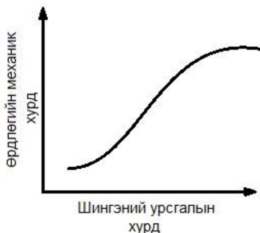
3 дугаар зураг. Угаалгын шингэний урсгалын хурд ба нэвтрэлтийн механик хурдны хамаарал
