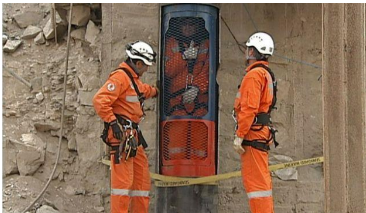
4 дүгээр зураг. Уурхайгаас цооногоор хүмүүсийг тусгай зориулалтын бортгоо ашиглан авран гаргаж байгаа байдал.
