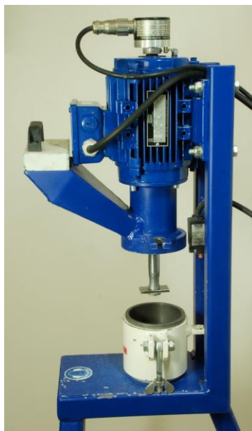
6 дугаар зураг. P18-579 (1990) Францын стандартаар LCPC-ын элээх чанарыг тодорхойлох багаж
