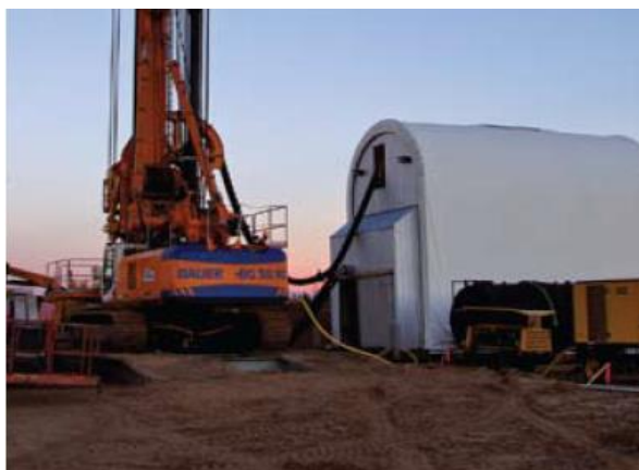
7 дугаар зураг. Канад-Германы Bauer BG 36маркийн том голчийн өрмийн төхөөрөмж.
