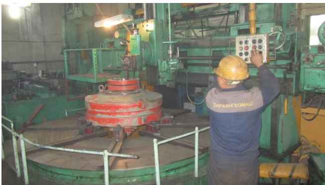
Өөрсдийн мэргэжилтнүүдийн угсарсан 3000мм хүртэл голчтой эд ангид шүд зорох чадвартай красуль токарийн машин
