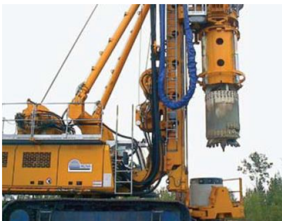
7 дугаар зураг. Канад-Германы Bauer BG 36маркийн том голчийн өрмийн төхөөрөмж.
