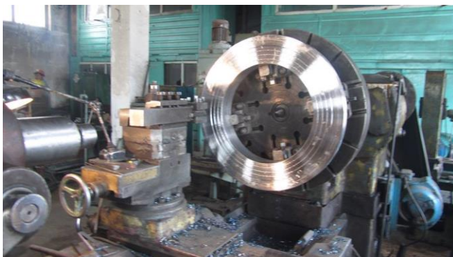
Уг машин дээр Оюутолгойн уурхайн тоног төхөөрөмжийн 28 инч (711.2мм)-ийн голчтой фланц зорж байгаа нь.
