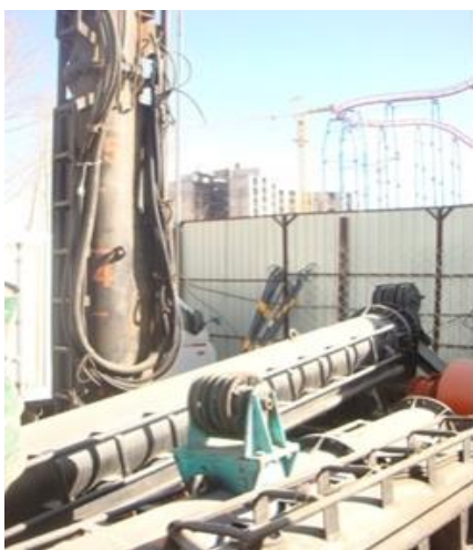
Барилгын суурийн том голчийн (600мм хүртэл) өрөмдлөг хийж, шууд суурь цутгах эсвэл даацын багана шургуулах төхөөрөмж
