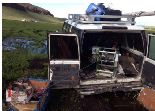
Зураг 10. Цооногт каротажийн хэмжилт хийж байгаа нь.2016.06.16
