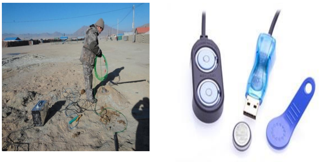
Зураг 6. Хэмжилтийн багажийг цооногоос сугалж буй байдал
