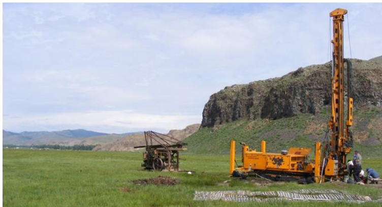
Зураг 18. “Гедротерм-1” цооно өрөмдлөгийн суурь машинууд
