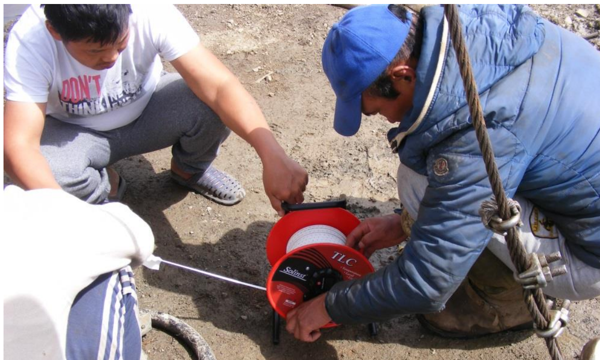
Зураг 16. Solinst TLC цахилгаан түвшин хэмжигчээр газрын доорх усны температур, эрдэсжилтийн хэмжээг тогтоогдсон гүнд тодорхойлж болдог .2016-06-28
