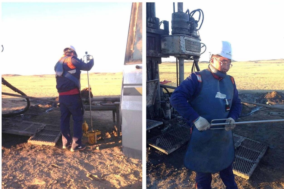
Зураг 12. Цацрагын үүсгүүр хэмжилтийн багажид холбож буй байдал.
