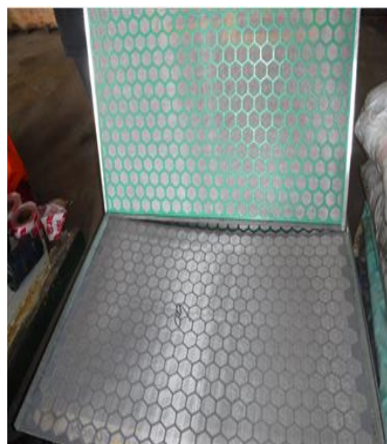
Зураг 8. Чичиргээт шавар шигшигч болон шигшүүрийн тор (2015 он)
