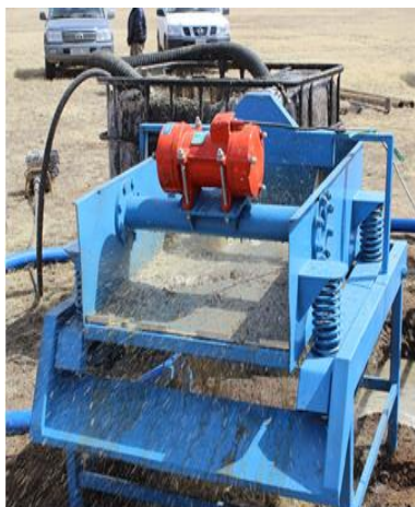
Зураг 8. Чичиргээт шавар шигшигч болон шигшүүрийн тор (2015 он)
