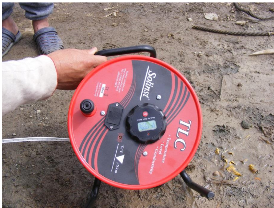
Зураг 17. Усны температурыг тодорхойлж байгаа нь. 2016-06-28
