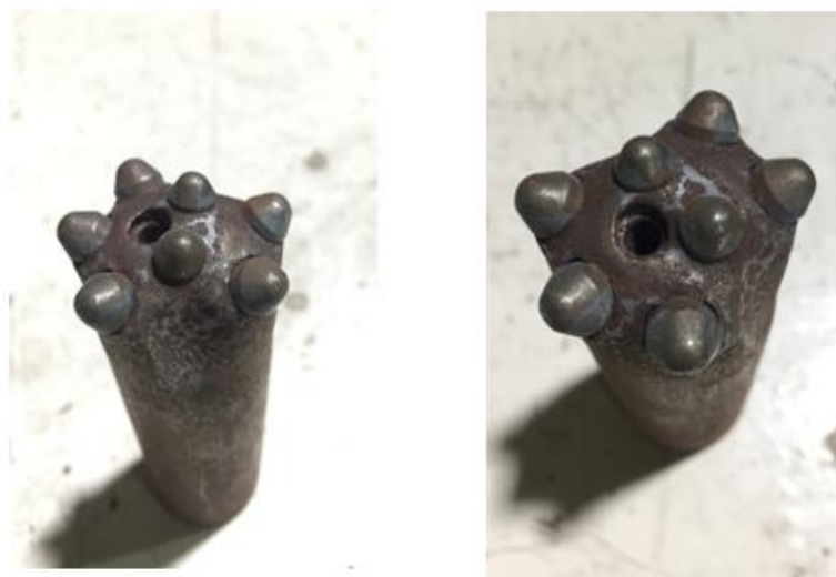
Зураг.6 Оюу толгойн ордын тэсэлгээ болон бэхэлгээний цооног өрөмдлөгийн үед өрмийн цүүцэнд үүсэх цүүцний товруунууд илүү цухуйх байдал
