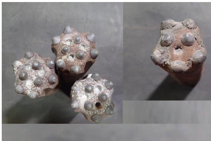
Зураг.5 Оюу толгойн ордын тэсэлгээ болон бэхлэгээний цооног өрөмдлөгийн үед өрмийн цүүцэнд үүсэх өрмийн цүүцний цэвэрлэгээний сувгууд бөглөрөх
