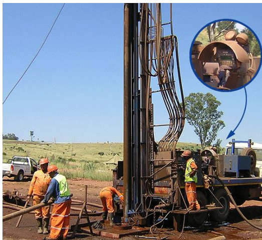
Зураг 3. ВАР-160 LUBAP төхөөрөмжийг өрмийн төхөөрөмжинд суурилуулсан байдал
