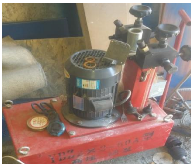
Зураг 8,9. -50 МПа, 3 кВ чадалтай. Цахилгаан гидро насосын зураг болон оросын гидро насосны жишээ зураг.
