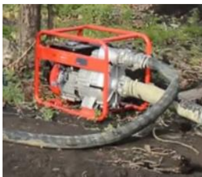
Зураг 10,11. Шавар-усны мотопомп /60-70м 3 /ц Ø=80мм/, шланг-сорох, гаргах-4метр, шүүр, муфт, 1.5м-тэй штанг конус резьбатай Ø=60,3мм х 5,5мм ба шнекны харагдах байдлын ерөнхий зураг. 1 штангны жин-14-15 кг.
