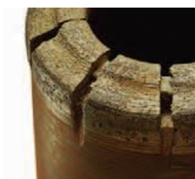
Гадагшаа налсан элэгдэл: Угаалт хангалтгүй бага байсан. Насос, яндангийн ус алдалтыг шалгах
