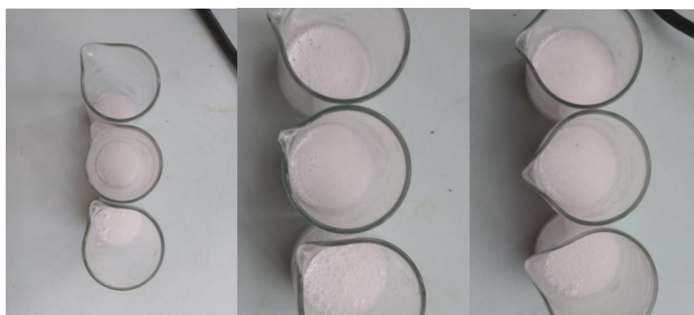
Рис. 1. Вид раствора (слева направо) при концентрации XC-0,6%; при концентрации XC-0,3%; при концентрации XC-0,4%; сравнение 3-х минутной, 6-ти минутной и 9-ти минутной обработки (сверху вниз)
