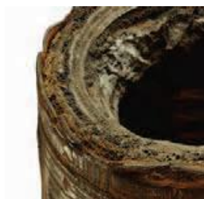
Шатаасан: Шингэн дутагдсан, хэт их дарсан. Насос болон янданг шалга, дотор янданг тохирүүлэх.
