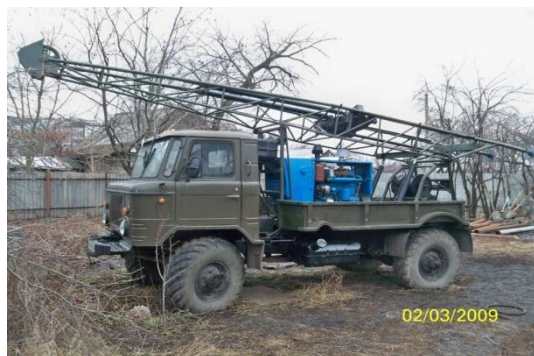
Зураг 1. УГБ-50М-00 (Газ 66 автомашин дээр суурилагдсан харагдах байдлын зураг)
