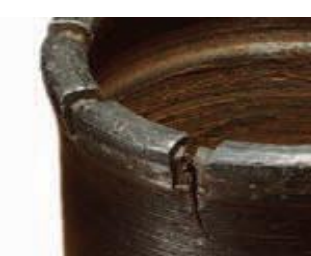
Усны суваг цуурсан: Хэт ачаалсан, дотор яндан хуурай шидсэн, хушууг механикаар базаж хагалсан.
