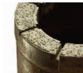
Алмазан ширхгүүд хэт ил гарсан: Матриц нь алмазнаас хэт түрүүлж элэгдсэн. Хэт их дарсан. Эргэлтийг нэм, доод серийн хушууг сонго.
