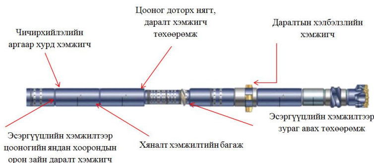
Зураг 2. Чиглэлтэй өрөмдлөгийн хяналт хэмжилтийн систем (MWD/LWD system)
