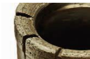
Аяга үүсгэсэн элэгдэл: Нэвтрэлт (даралт) их эргэлт харьцангуй бага.
