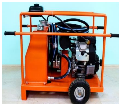
Зураг 8,9. -50 МПа, 3 кВ чадалтай. Цахилгаан гидро насосын зураг болон оросын гидро насосны жишээ зураг.
