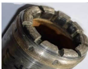
Гадар голч элэгдсэн: Циркляц бага, Нарийссан, чичиргээ үүснэ. Шингэний урсгалыг нэм, эргэлтийг өөрчил
