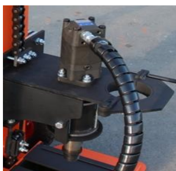
Зураг 6,7. Төлөвлөж буй гидромотор (850Н/м), хувиарлагчийн жишээ
