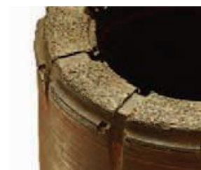
Дотор голч элэгдсэн: Дээж хаягдаж өрөмдөгдсөн, угаалт хангалтгүй. Дээж авагчийг шалга, тохируул.
