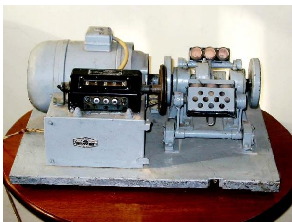
10 дугаар зураг. Чулуулгийн элээх чанарыг тодорхойлох ПОАП-2М багаж
