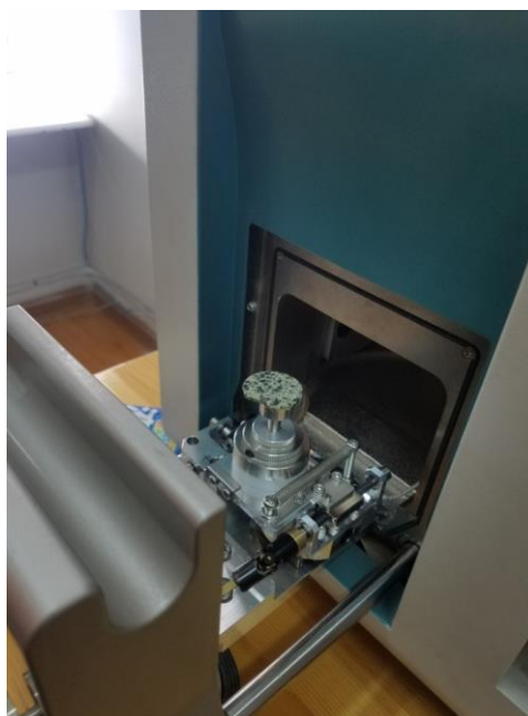
14 дүгээр зураг. Чулуулгийн химийн элемент тодорхойлох Hitachi TM-1000 багаж
