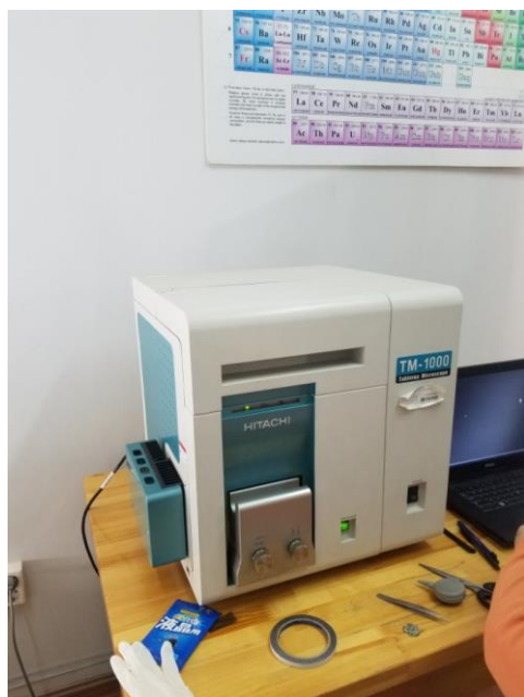
14 дүгээр зураг. Чулуулгийн химийн элемент тодорхойлох Hitachi TM-1000 багаж
