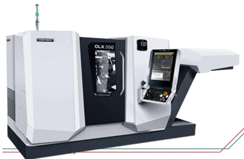
Зураг-4. CNC токарийн суурь машин DMG MORE CLX -350
