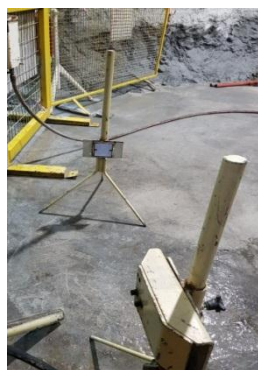
6 дугаар зураг. ENTERLOCK, LAZER BEAM төхөөрөмж
