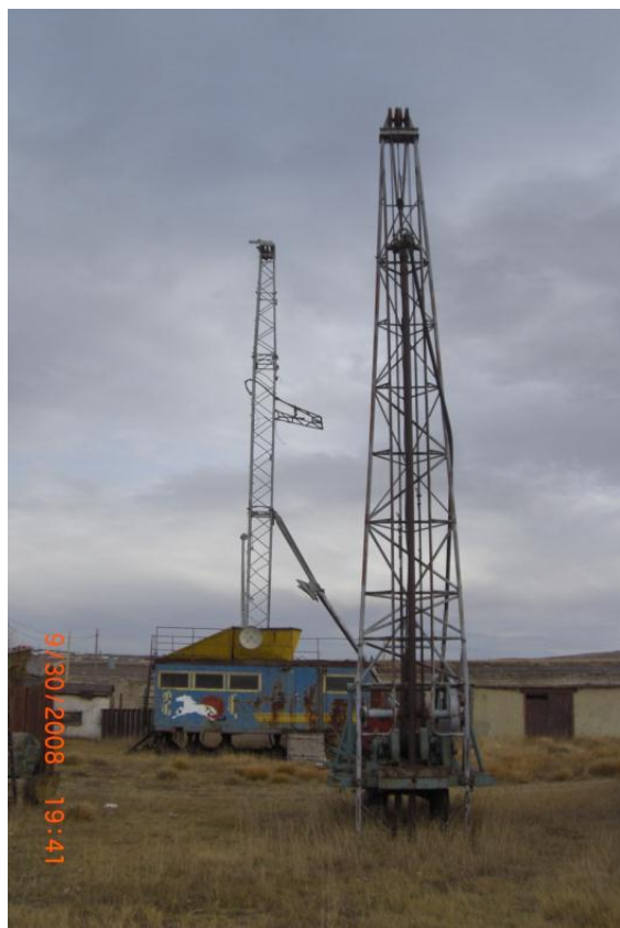
Зураг-5. Зүүнбаянгаас ЗИФ1200МР өрмийн төхөөрөмжийг полигонд авч ирж угсрав (2007он)
