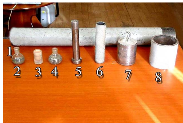
1-р зураг. Чулуулгийн динамик бат бэх тодорхойлох ПОК багаж 1 - чиглүүлэгч хоолой, 2 - корундын нунтаг, 3 - ачааллах цилиндр, 4 - хар тугалган үрэл, 5 - хуваарьтай бүлүүр, 6 - эзэлхүүн хэмжигчийн цилиндр, 7- туухай, 8 - аяга.
