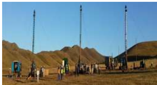
3-р зураг. Геологи-хайгуулын цохилтот өрөмдлөгийн төхөөрөмжүүд, явагдах ерөнхий байдал (Монгол улсын Төв аймгийн Заамарын алтны шороон ордын жишээ дээр, 2017 он)
