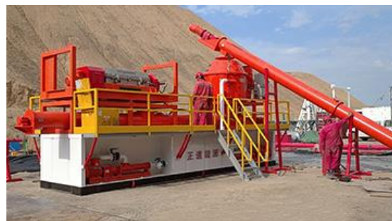
5 дугаар зураг. Хаалттай өрөмдлөгийн систем Эх сурвалж: БНХАУ-ын “Брайт Вэй” ХХК
