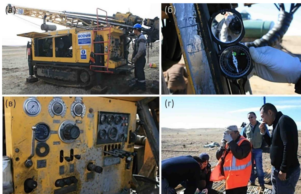
4-р зураг. а. Өрөмдлөгийн Power суурь машин, б. цооногийн хазайлтыг тохируулж байгаа явц, в-г. өрөмдлөгийн ажлын явц
