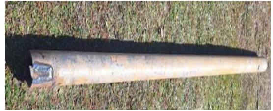
3 -р зураг. Өрөмдлөгийн шүдийг хайгуулын суманд гагнаж тоногдосон байдал
