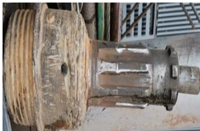
6 -р зураг. Шууд үлээлгэт хийн цохилуурт, эргэлтэд өрөмдлөгийн хушуунд хийсэн өөрчлөлт
