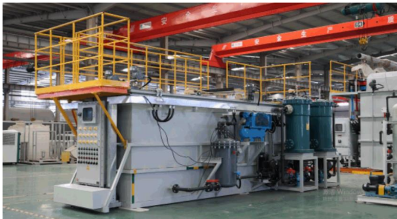
3-р зураг. LQF загварын химийн бүтээгдэхүүнээр бохирдсон ус цэвэршүүлэх төхөөрөмж
