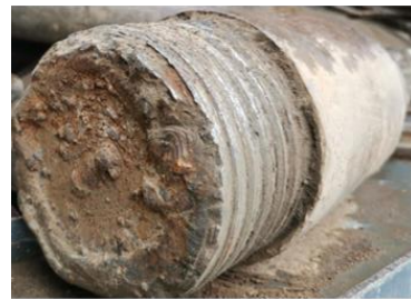
5 -р зураг. Шууд үлээлгэт хийн цохилуурт, эргэлтэд өрөмдлөгийн хушуунд хийсэн өөрчлөлт
