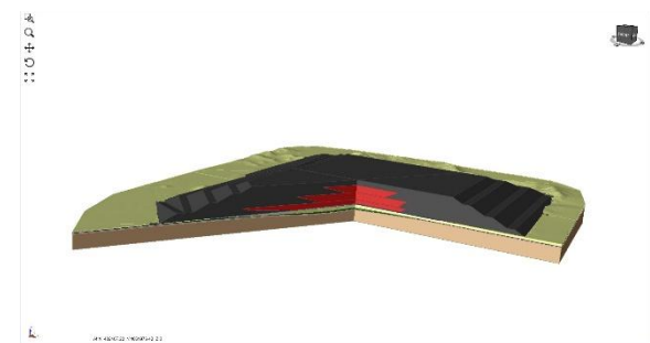
2-р зураг. Хөрсний овоолго, баяжуулах үйлдвэрийн хаягдлыг нэгтгэсэн байгууламжийн гурван хэмжээст загварчлал
