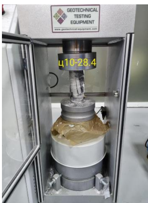
4-р зураг. Нэг тэнхлэгийн дагуух шахалтын бат бөхийн хязгаарыг тодорхойлсон туршилт
