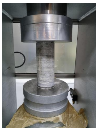
4-р зураг. Нэг тэнхлэгийн дагуух шахалтын бат бөхийн хязгаарыг тодорхойлсон туршилт
