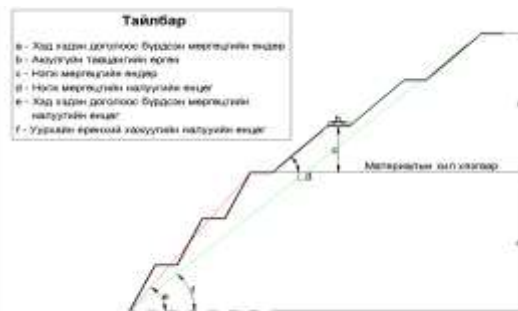
Зураг 2. Уурхайн хажуугийн үндсэн элементүүдийн схем
