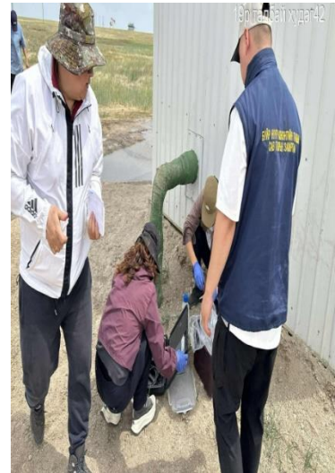
Зураг 2. Уст цэгт хээрийн хэмжилт хийж буй болон гидрокарбонатын ионыг тодорхойлж байгаа байдал
