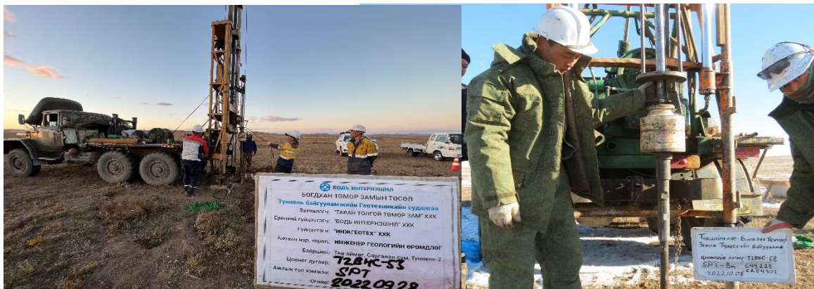
1 дүгээр зураг. Талбайн стандарт пенетрацийн туршилт
