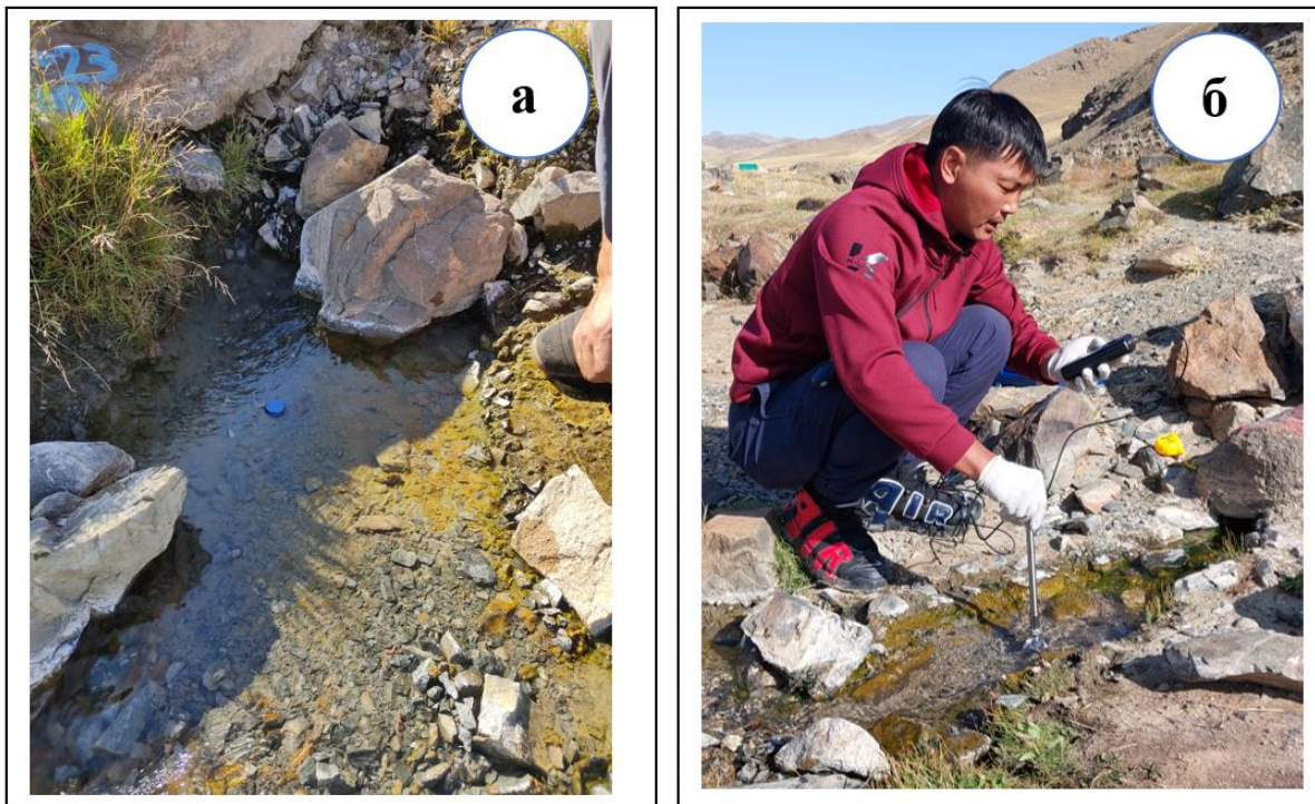
Зураг 5. а) Хөвүүрийн аргын хэмжилт, б) Дижитал фловметрийн хэмжилт
