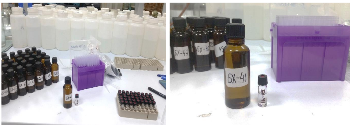
Зураг 3. Хээрийн нөхцөлд авсан дээжийг багажийн автомат дээж авагчид суурилуулна.
