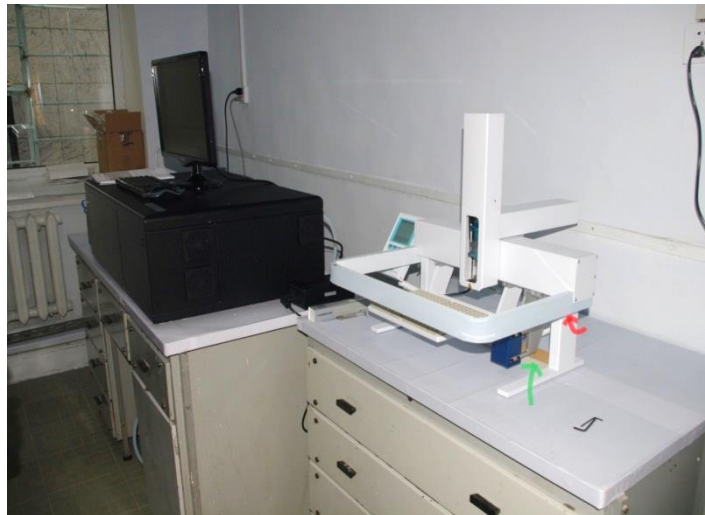
Зураг 2. Тогтвортой изотоп тодорхойлогч лазер спектроскоп
