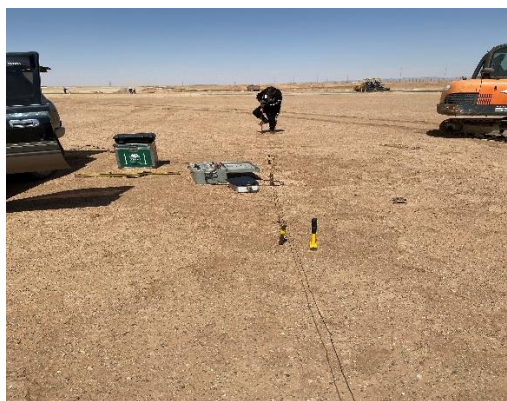
2 дугаар зураг. Судалгааны талбайн ул хөрсний хувийн цахилгаан эсэргүүцэл, дулаан дамжуулах чадварын туршилт
