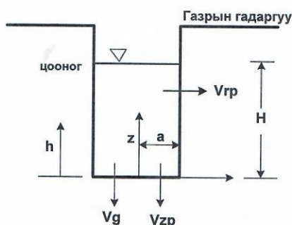
5-р зураг. Цооног дахь усны урсгалын схем
