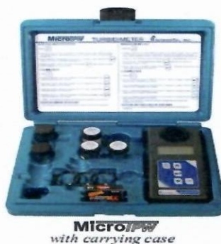
Зураг 2. Усны рН, температур, ЦДЧ, TDS, булингаршил тодорхойлогч багаж
